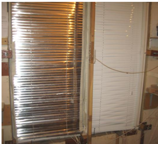
Рис. 1. Жалюзи очищенные (слева) и эмалированные (справа)
