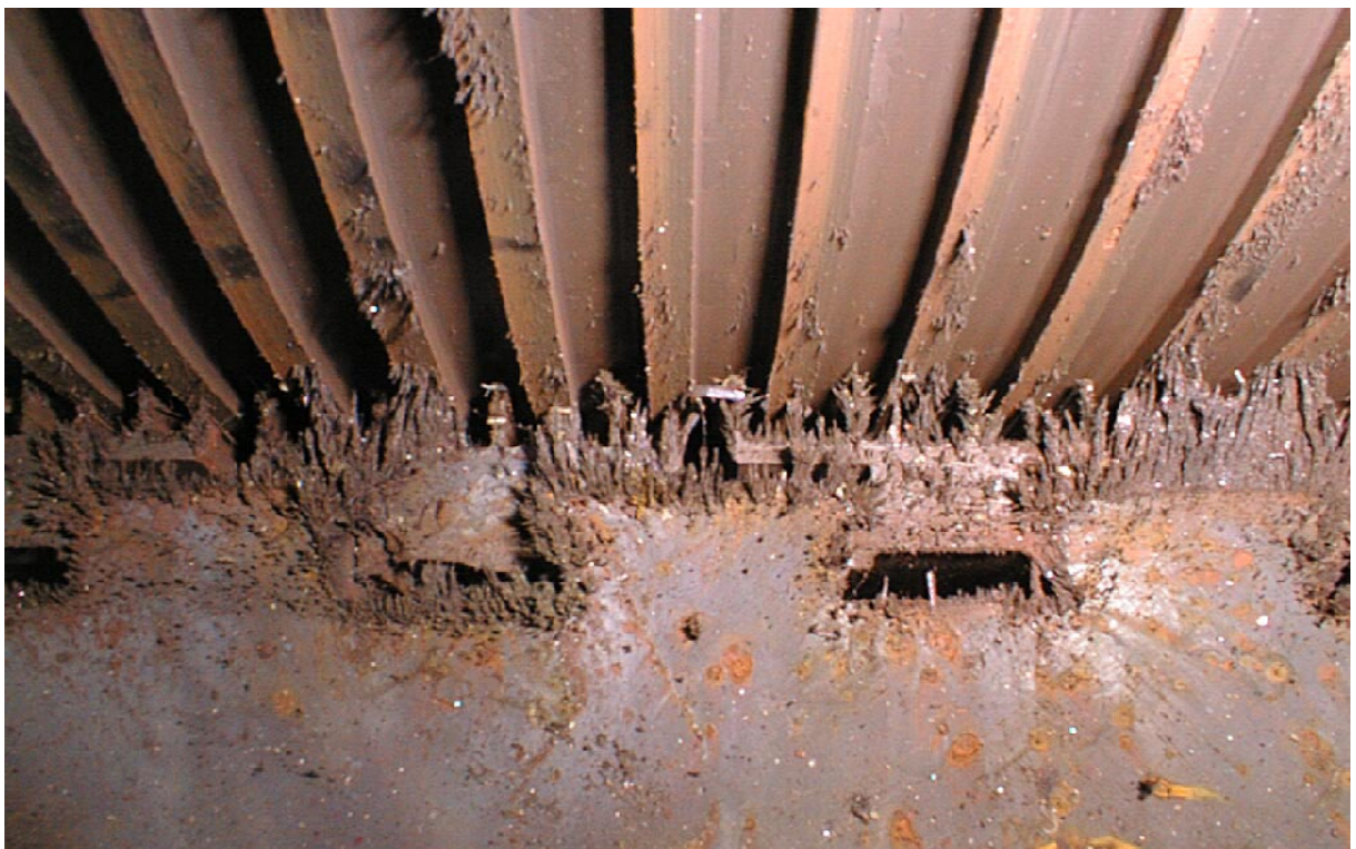
Рис. 2. Участок горизонтального разреза ЦВД с ориентированными в магнитном поле коррозионными и металлическими включениями после задеваний в проточной части
