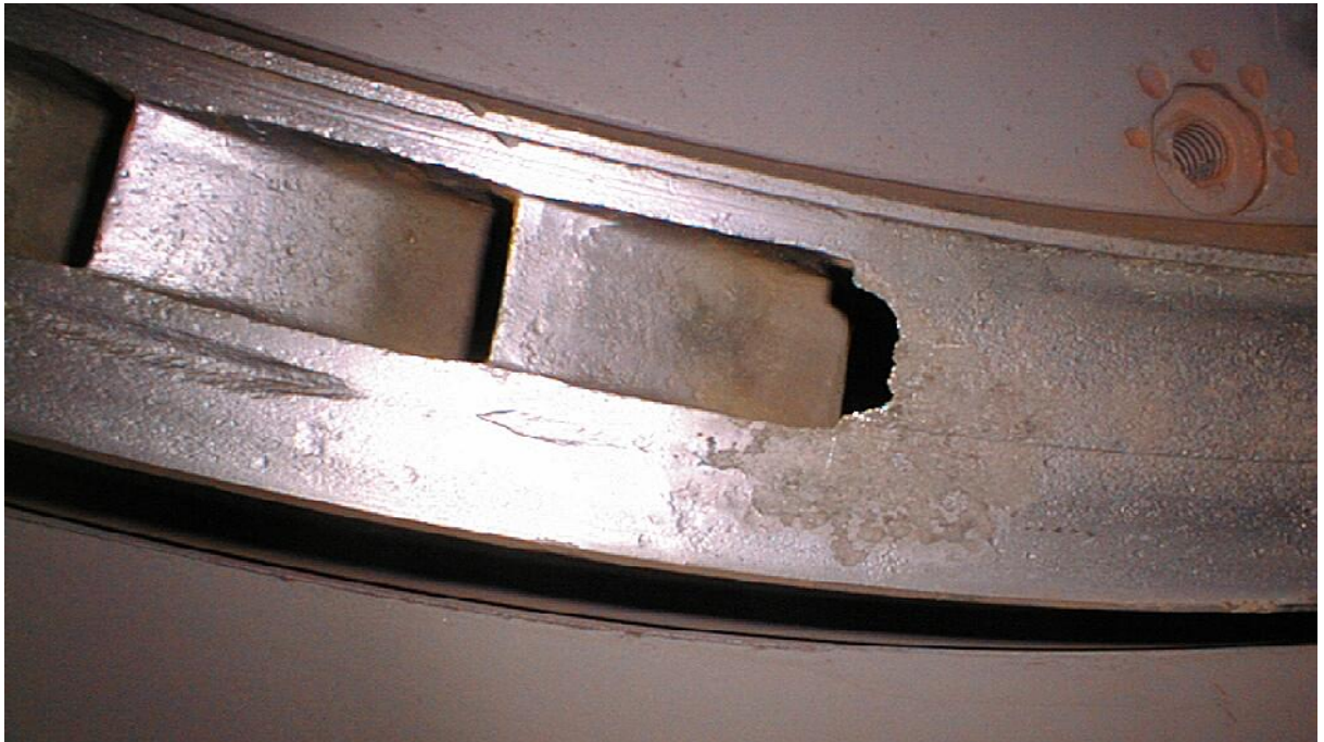
Рис. 1. Эрозия (электроэрозия) соплового сегмента сопловой коробки
