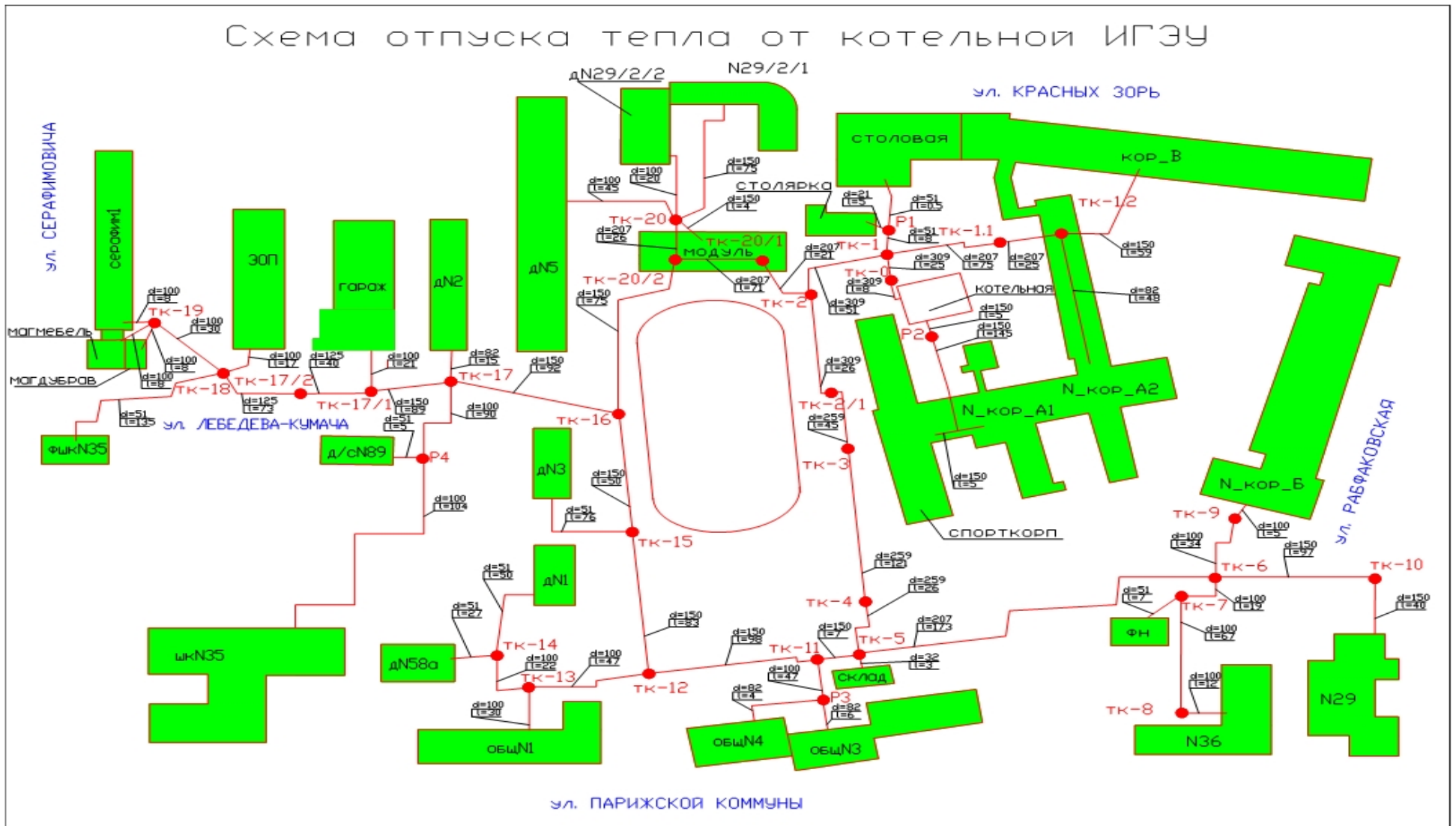
Рисунок 4.1 - Схема тепловых сетей от котельной Ивановского Государственного энергетического университета.
