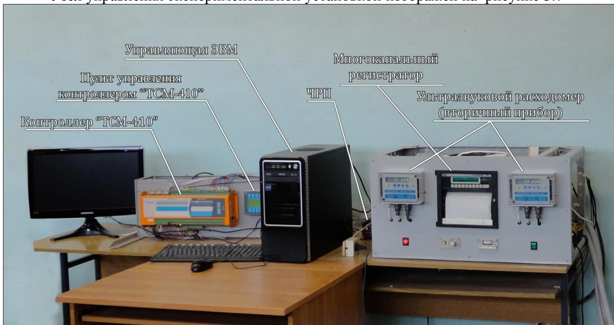
Рисунок 3.7 - Узел управления экспериментальной установкой
