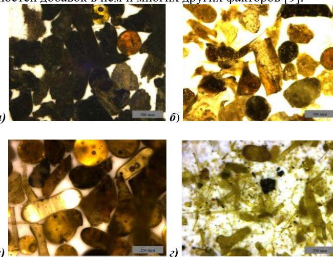
Рис. 1 Форма частиц отходов производства минеральной ваты
