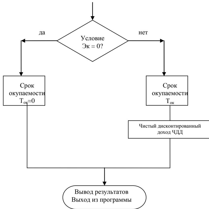
**Рисунок 1.4** – Блок-схема определения оптимальной толщины теплоизоляции при надземном способе прокладки трубопроводов.
