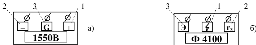
Рис. 4. Схемы обозначений клемм мегомметров: а – FLUKE 1550В; б – Ф 4100; 1 – высоковольтный вывод; 2 – измерительный вывод; 3 – защитная клемма (экран)
