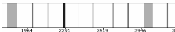
Рис. 2. Участок временного графика выполнения «наивной» реализации итераций Чебышёва (время простоя оборудования обозначено белым)
