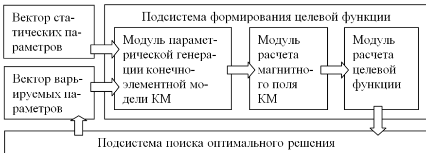
Рис. 1. Структура оптимизационной модели КМ
