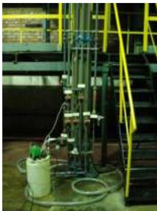
Рис. 1. Модель механического фильтра
