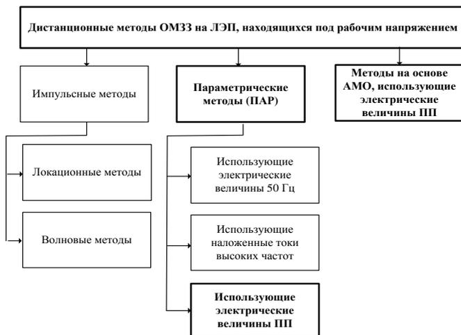
Рис. 1. Классификация методов ДОМЗЗ на линиях, находящихся под рабочим напряжением
