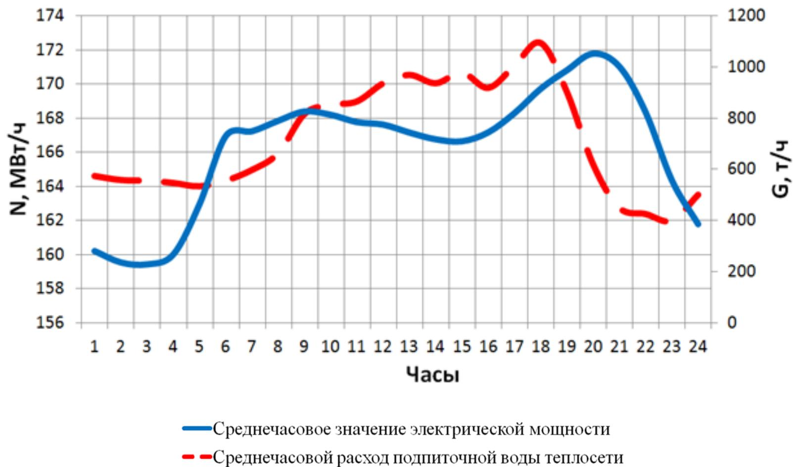
Рисунок 4.4. График зависимости выработки электроэнергии и подпитки теплосети в отопительный период
