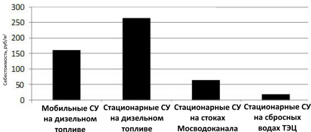
Рисунок 1.7. Удельная стоимость утилизации снега на различных типах снегоплавильных установок
