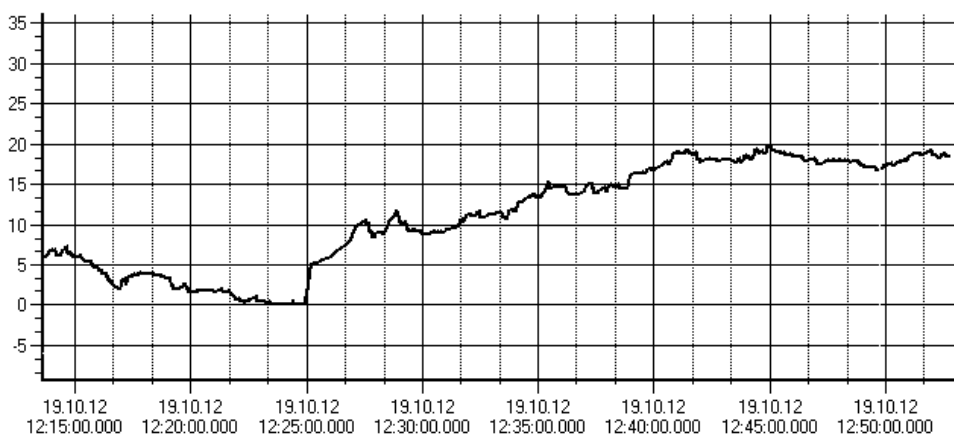
Рис. 3.21. Изменение коэффициента регулятора блоком подстройки
