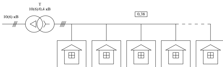
Рис. 1. Существующая схема электроснабжения коттеджей
