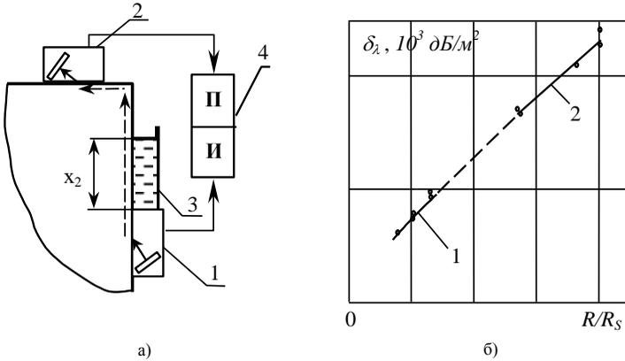
Рис.3. Схема эксперимента (а) и зависимость коэффициента затухания ПАВ на границе МЖ-металл от  $R'=R/R_S$  (б): 1,2 – излучатель и приемник ПАВ; 3 – МЖ; 4 – источник и приемник УЗК; б) металл: 1 – сталь; 2 – алюминий
