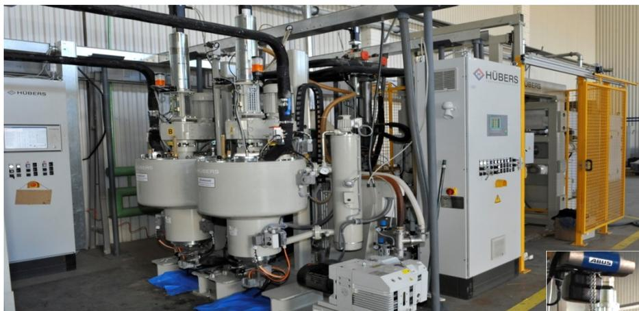
Литьевая машина для производства изолирующих распорок элегазового оборудования
