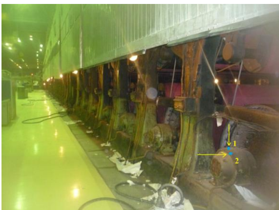
Рис. 2. Сушильный цилиндр БДМ: 1 – вертикальное, 2 – осевое направления
