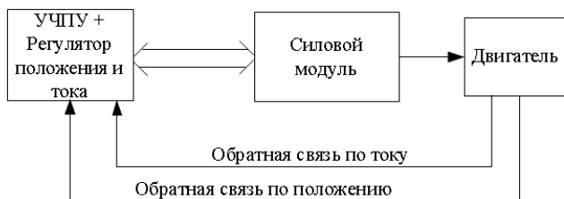
Рис. 2. Структура ЭП с вынесенным регулятором положения
