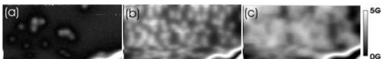
Рис. 1. Вихревая решётка в монокристалле рутената стронция, полученная во внешнем магнитном поле 0,0002 Тл (а), 0,0006 Тл (б) и 0,0007 Тл (с). Светлые участки соответствуют вихревым образованиям (областям, куда проникло магнитное поле) [1]
