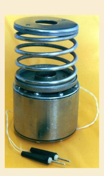
ФМЖ на ПМС, будучи инертными и пожаробезопасными, а также обладая низкотемпературными высокотемпературными характеристиками, могут использоваться для эффективного гашения колебаний. Применение ФМЖ в рабочей качестве среды магнитожидкостных демпферах позволяет демпфирующие устройства, в создавать возможно изменение силовой которых характеристики и энергии вязкостной диссипации за счет изменения воздействующего на ФМЖ магнитного поля, вызываемого, например, регулируемым током катушки возбуждения.
