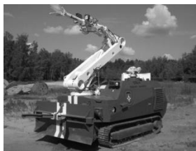
Рис. 1. «Ель-4» — робототехнический комплекс пожаротушения среднего класса
