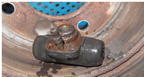
Рис. 1. Неисправный рабочий тормозной цилиндр
