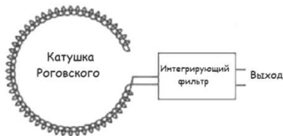
Рис. 1. Измерительный преобразователь тока с катушкой Роговского
