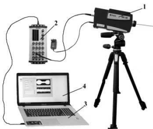
Рис. 1. Схема ИДК: 1 – лазерный доплеровский виброметр; 2 – многофункциональный модуль ввода-вывода; 3 – персональный компьютер; 4 – программное обеспечение
