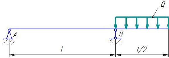
Определить величину  $q$  если  $l=4\text{м}$ ,  $z_{\max}=0,011\text{м}$ , двутавр №20.
