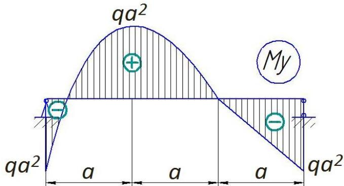
Для однопролетной балки по заданной эпюре изгибающих моментов построить эпюру поперечных сил и определить нагрузку, действующую на балку.
