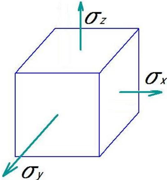
Найти соотношение между  $\sigma_x$ ,  $\sigma_y$ ,  $\sigma_z$ , при котором возникает одноосная деформация в данном элементе.
