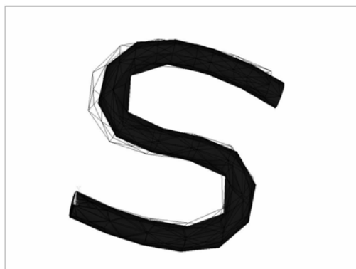
Рис. 7. Восстановление формы после удаления нагрузки и нагрева до 35 °С
