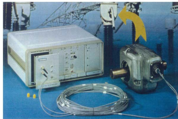
Рис. 8. Датчик тока фирмы SIEMENS AG Corporate
