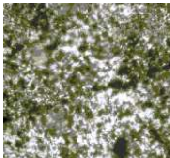
Рис. 2. Структура сплава Д16 в зоне лазерного оплавления миллисекундным импульсом интенсивностью 200 \text{ кВт/см}^2 : а) ув. \times 400 , б) ув. \times 1000
