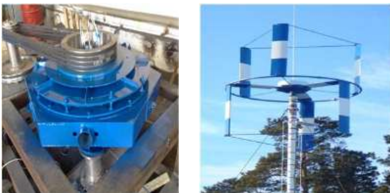
Рис. 4. Генератор и ветроэнергетическая установка 3 кВт
