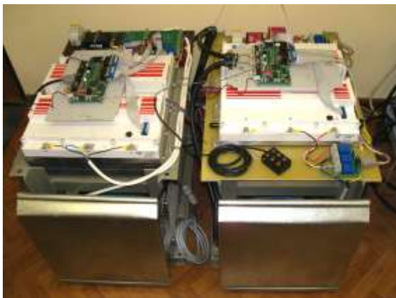
Рис. 1. Привод ТАД + имитатор нагрузки и имитатор ДВС + привод МГ макета тягового электрооборудования
