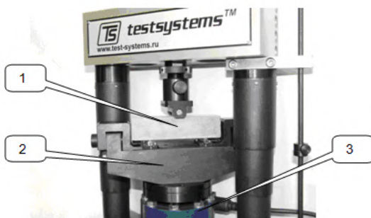
Рис. 2. Испытания на изгиб: 1 – испытываемый образец; 2 – приспособление для испытания на изгиб; 3 – датчик силы
