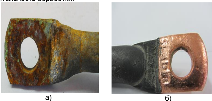
Рис. 2. Поверхность обрабатываемого изделия: а) до очистки; б) после очистки
