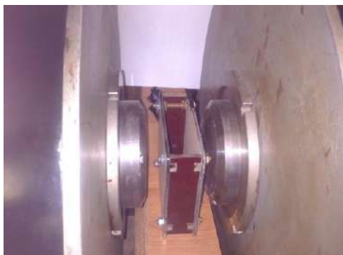
Рис.6. Ячейка между наконечниками установки ФЛ-1
