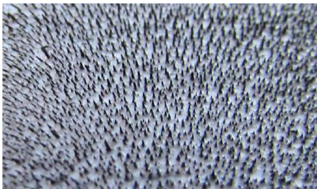
Рис 3. Структурирование поверхности магнитоактивного эластомера под действием магнитного поля в процессе полимеризации образца в магнитном поле
