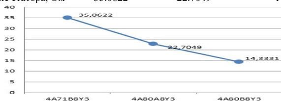
Рисунок 1 - График сопротивления статора  $R_s$
