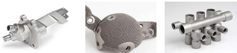
Рис. 1. Примеры металлических изделий, выполненных с применением аддитивных технологий
