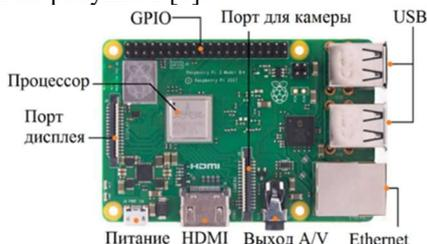
Рис1. Внешний вид одноплатного микрокомпьютера Raspberry Pi 3
