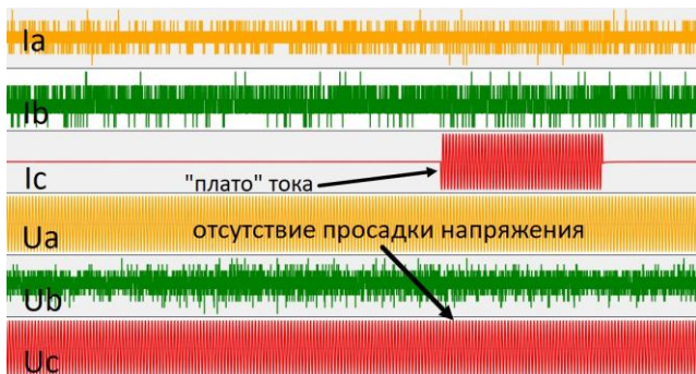
Рис. 3. Пример ложного срабатывания алгоритма: испытательный режим с идеальным «плато» тока и отсутствием просадки напряжения.
