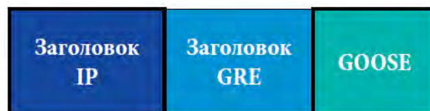
Рис. 2. Инкапсуляция GOOSE по GRE-IP
