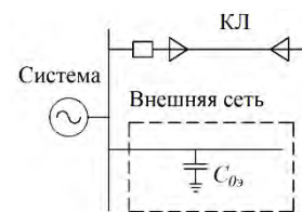
Рис. 1. Схема замещения электрической сети
