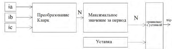
Рис. 2. Схема пускового органа одномерной защиты
