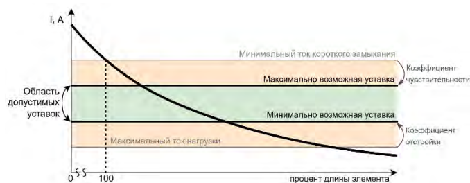
Рис. 1. Допустимая область уставок для токового измерительного органа
