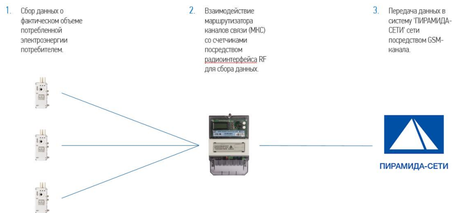
Рис. 1. Схема удаленного опроса счетчиков
