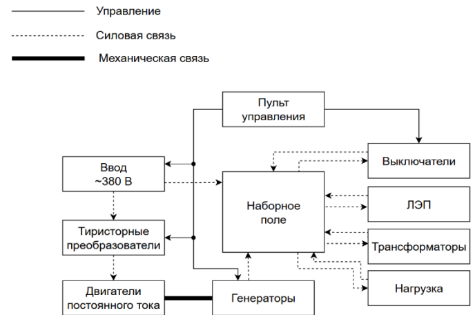
Рис. 1. Структурная схема ЭДМ НГТУ
