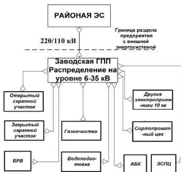
Рис. 1. Упрощенная структурная схема промышленного предприятия (АБК – административно-бытовой корпус; ЭСПЦ – электросталеплавильный цех; БРВ – блок распределения воды)
